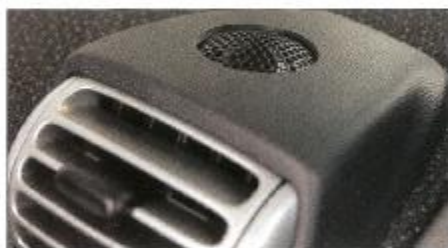
Originell: Die 25-mm-Tweeter sind in die Belüftungskanäle integriert.
