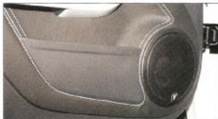
Wachstum: Größere Lautsprecheraufnahmen mit passenden Abdeckgittern lassen die neuen Tieftöner in der Smart-Tür elegant wirken.
