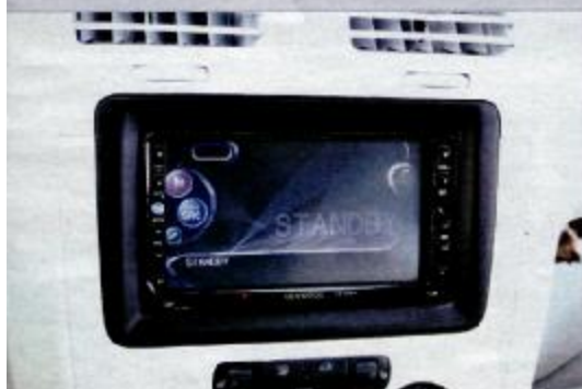
Der Kenwood-DVD-Monitor im Doppel-DIN-Format bekam aus optischen Gründen einen speziell angefertigten Rahmen
