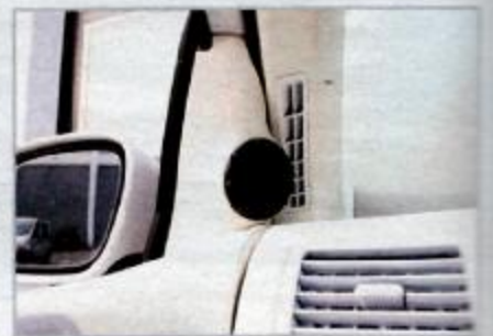
Die Hochtöner wurden an den A-Säulen in eigens dafür angefertigte GFK-Gehäuse verbaut
