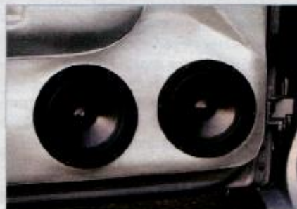
Die Kickbass-GFK-Gehäuse in den Türen sind komplett geschlossen, was für eine knackige Impuls wiedergabe sorgt
