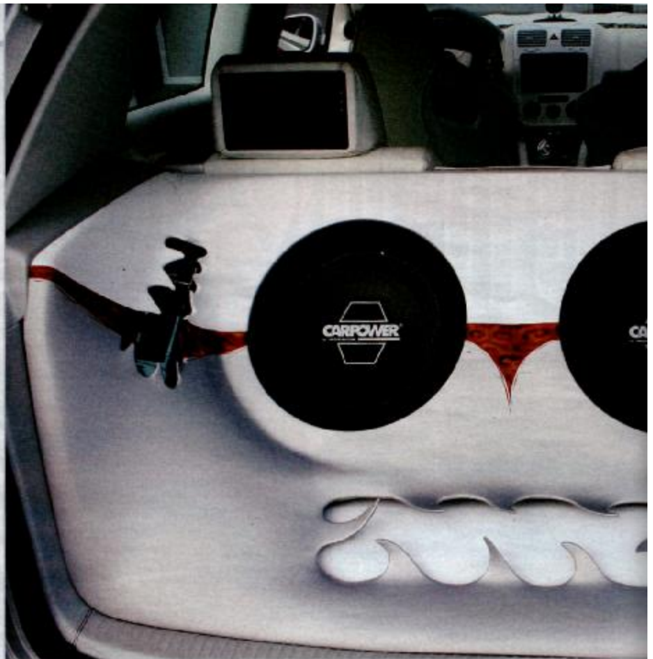
Hinter der GFK-Formschale verbirgt sich das große geschlossene Bassgehäuse für die zwei "Sonic-12"-Subwoofer
